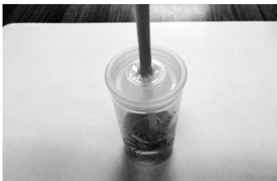
写真3 本研究で製作した手作り温度計
