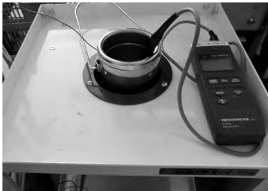
写真2 熱電対温度計とデュワー瓶
