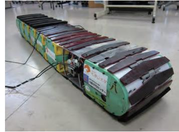
図-16 柔軟全周囲クローラ (FMT) システム
