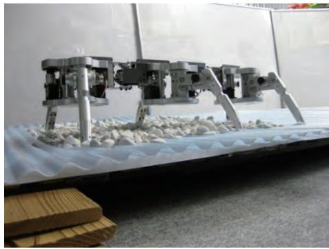
図-14 軟弱な足場対応ロボット試作機
