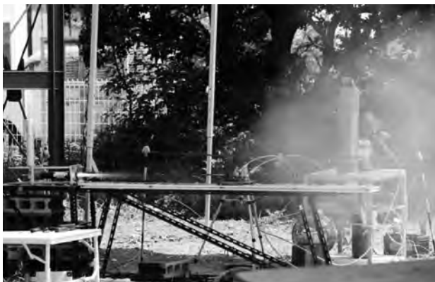
図10. 同タイプのロケットモータの地上燃焼試験の様子
