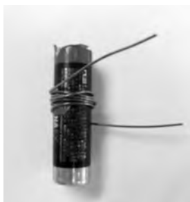
図1 エナメル線を電池に巻いて輪を作る
