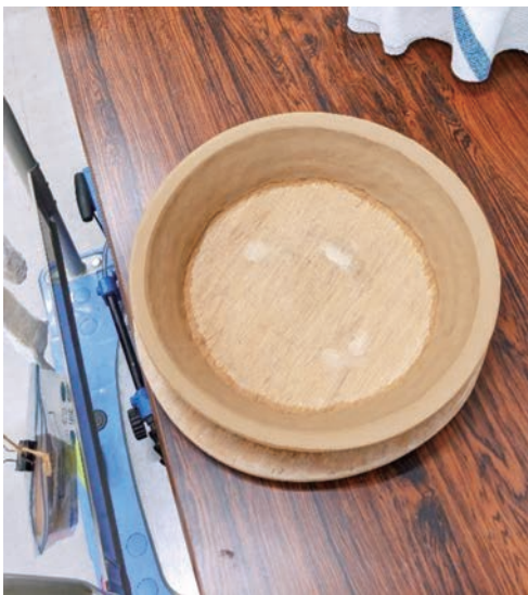
図9 教材の生素地段階である。教材(陶器)は焼成する際、安定的に凹形状を保つために「ハマ」と呼ばれる焼成補助台を使用して焼成する。写真はその「ハマ」を上から見たところ。
