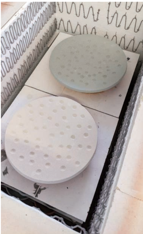
図19 シャモット(焼き粉)の上に「ハマ」、その上に教材を載せて窯詰めした様子。
