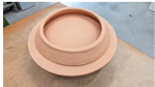
図17 写真の通り「ハマ」は教材の周辺から内側に50mm程度の部分を支えるようになる。また「ハマ」により教材の底はカーボランダム(焼成時に窯の中で使用する棚板)に接触しない。
