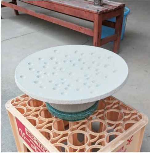
図13 教材Aの釉薬掛けの様子である。教材Aには織部釉を施した。教材の大きさや釉薬の厚みが均一になることを考慮して霧吹きによる施釉とした。※写真奥に見えるのは金属製霧吹き器。
