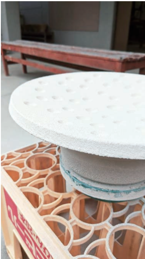
図14 教材Bには白マット釉を施した。釉薬を掛けた際に横から見たところ。
