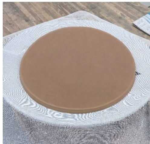
図6 粘土を手で叩き厚みが15mm程度になるまで延ばし、それを直径370mm程度の円形に切り取る。円形の粘土の板を蚊帳布を敷いた型の上に乗せて凹の形状にする。つぎに適当な大きさのボウルに載せ替え、手などを使ってより深い凹の形状にする。
