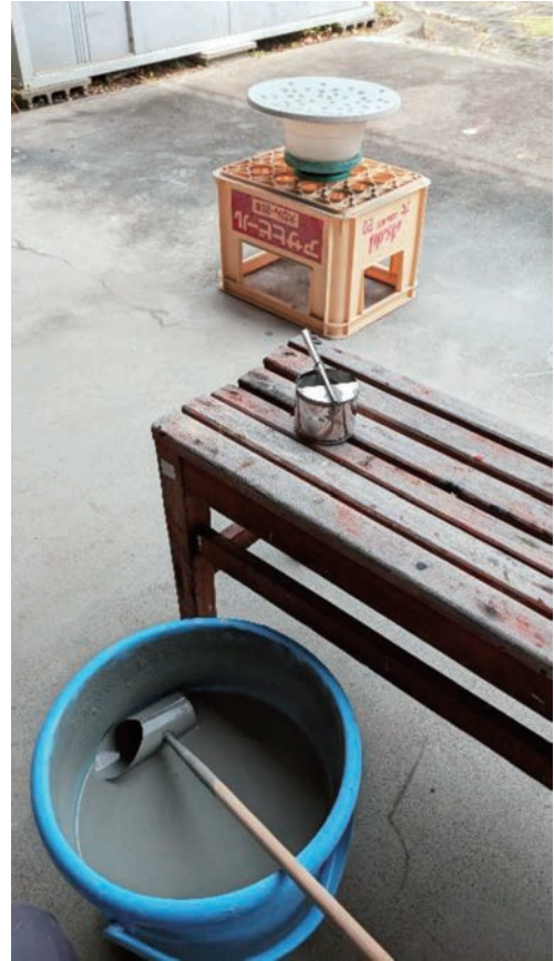
図15 教材の釉薬掛けの様子(全体)。手前にあるのは釉薬バケツと柄杓、金属製霧吹き器。
