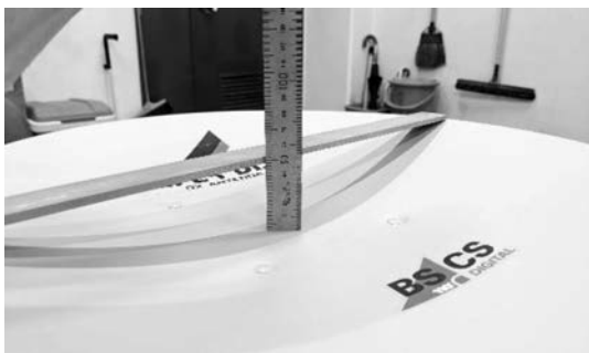
図4 パラボラアンテナの深さはおよそ50mm。
