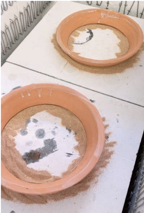
図18 窯の中で「ハマ」を棚板上に置いた状態。「ハマ」は本焼きの際に焼き縮むので棚板上での滑りを良くするためにシャモット(焼き粉)を敷いて置く。
