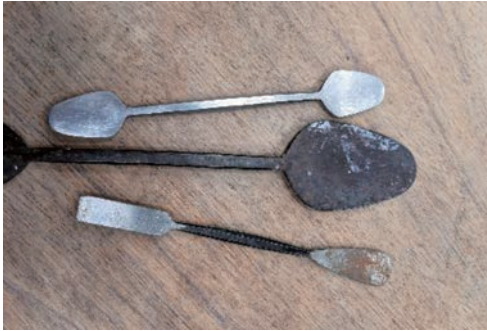
図7 生素地内側の窪みを掘るために使用した道具。一般的な陶芸用具ではなく彫塑制作に使用する金属製のヘラである。
