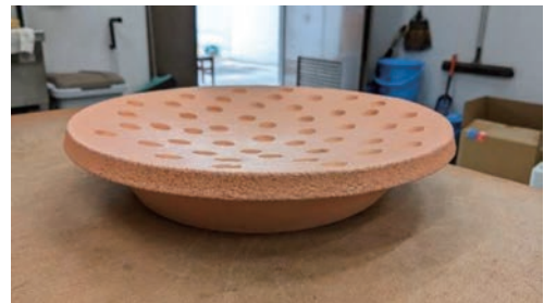
図16 焼成時の教材と「ハマ」の組み合わせ(上下の関係)。この状態で窯の中に入れて焼成する。
